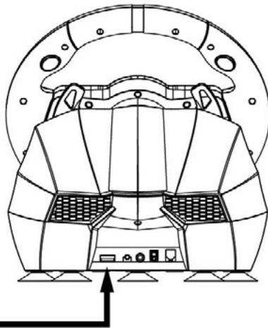
3. Collegare il controller DualShock4™ originale con il cavo alla porta USB sul volante (il controller DualShock4™ deve essere spento).
