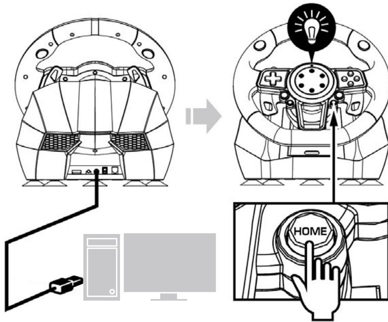
2. Ligar o cabo USB do volante à porta USB do PC. Quando o LED vermelho do volante acender, pressionar o botão “HOME” para finalizar a ligação do volante
