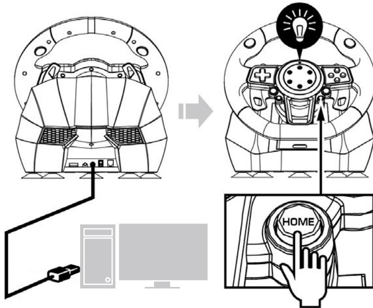
2. Connectez le câble USB du volant au port USB du PC. Lorsque la LED rouge sur le volant s'allume, appuyez sur la touche « HOME » pour terminer la connexion du volant.
