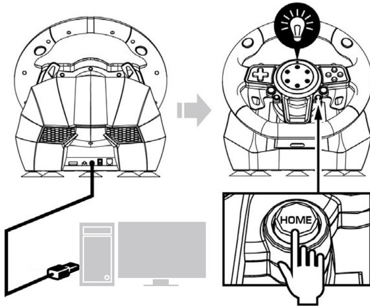
2. De USB-kabel van het stuur aansluiten op de USB-poort van de PC. Wan-
