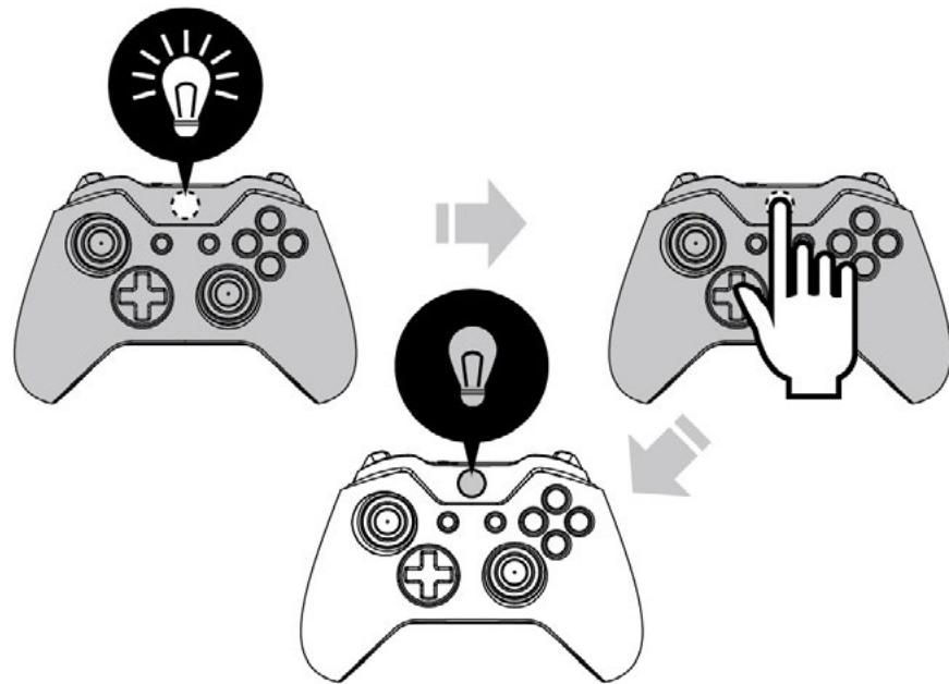
2. Spegnere il controller XB (il LED acceso significa che il controller XB è collegato alla console Xbox™): Premere il pulsante X sul controller XB finché la luce del LED non si spegne.
