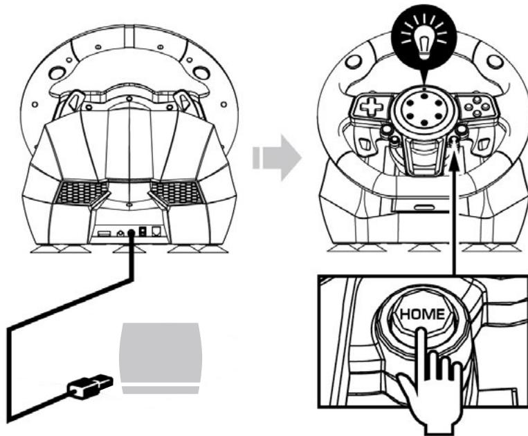
2. Connecteu el cable USB del volant a la PS3™ i premeu el botó "HOME" per connectar el volant. El LED vermell del volant s'encendrà quan acabi la connexió.
