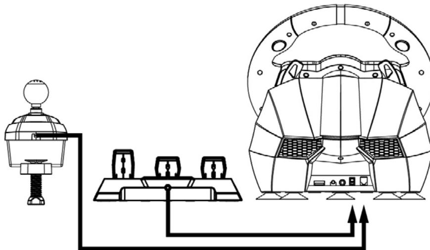
1. Connectez les pédales et le levier de vitesse manuel aux ports correspondants sur le volant.
