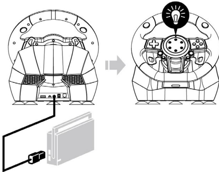
3. Connecteu el volant de connexió mitjançant el cable USB al port USB ubicat al Dock™ de Nintendo Switch™. Quan el LED vermell del volant estigui encès, ja està a punt per fer-lo servir.
