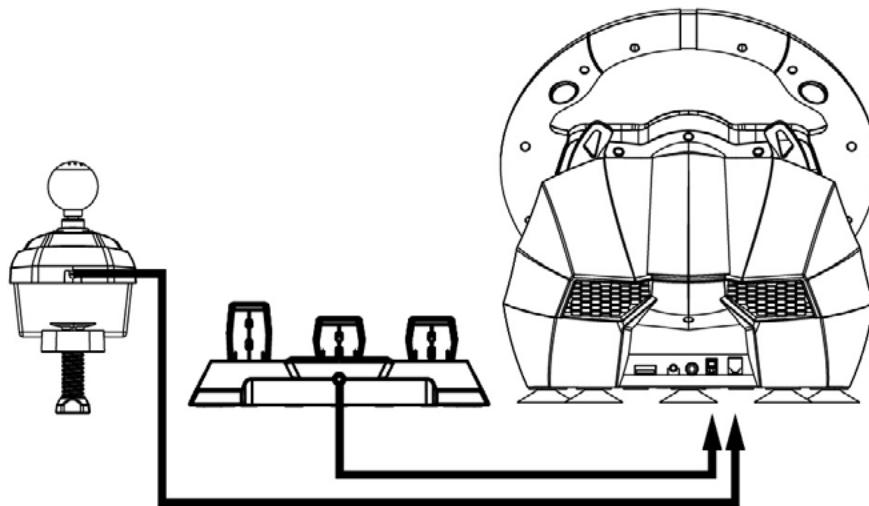
1. Conectar los pedales y el cambio de marchas manual a los puertos correspondientes en el volante de conducción.
