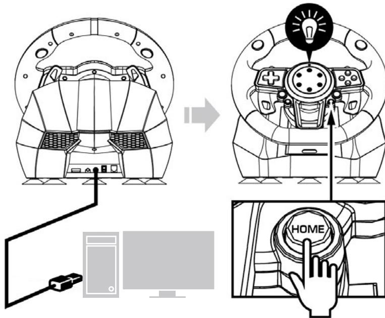
2. Connecteu el cable USB del volant al port USB del PC. Quan el LED vermell del volant s'encengui, premeu el botó "HOME" per finalitzar la connexió del volant.
