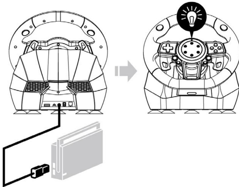
3. Ligar o volante de ligação através do cabo USB à porta USB localizada no Dock™ da Nintendo Switch™. Quando o LED vermelho do volante estiver aceso, já está pronto para utilizar.
