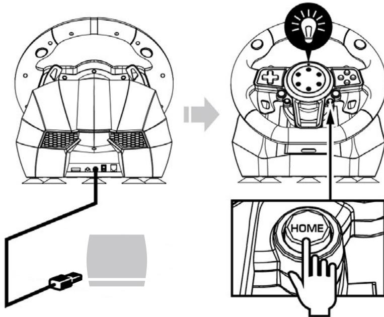
2. Collegare il cavo USB del volante alla PS3™ e premere il pulsante "HOME" per il collegamento del volante. Il LED rosso sul volante si accende a collegamento avvenuto.
