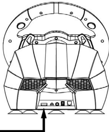
3. Den XB Original-Controller über das Leitkabel mit dem USB-Port des Lenkrads verbinden. (Der XBOX ONE™ oder XBOX Series X/S Controller muss ausgeschaltet sein.)
