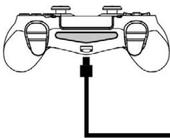
3. Connecteu el comandament DualShock4™, amb el cable guia, al port USB del volant.
