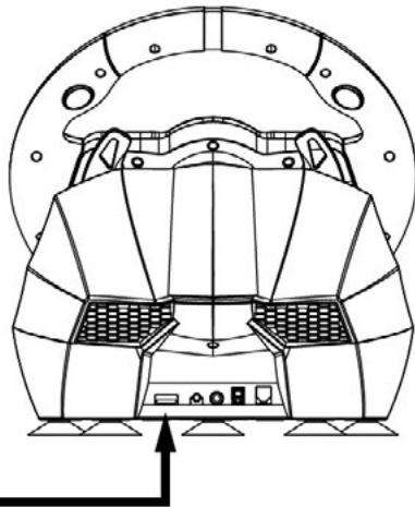
3. Connecteu el comandament original XB, amb el cable guia, al port USB del volant.
