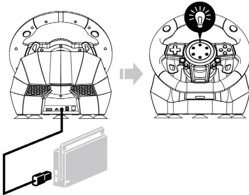
3. Schließen Sie das USB-Lenkradkabel am USB-Port auf dem Dock der Nintendo Switch™ an. Sobald die rote LED des Lenkrads leuchtet, ist das Lenkrad einsatzbereit.
