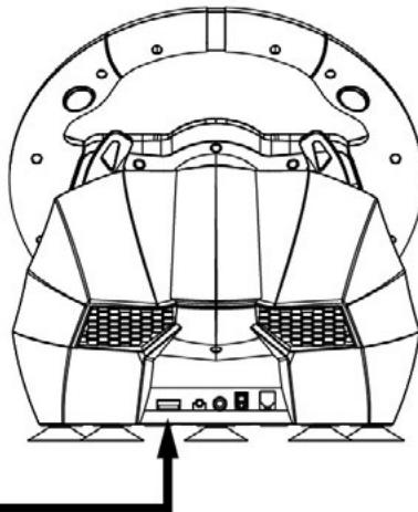
3. Ligar o comando original DualShock4™, com o cabo guia, à Porta USB do volante. (O comando DualShock4™ deve estar desligado)
