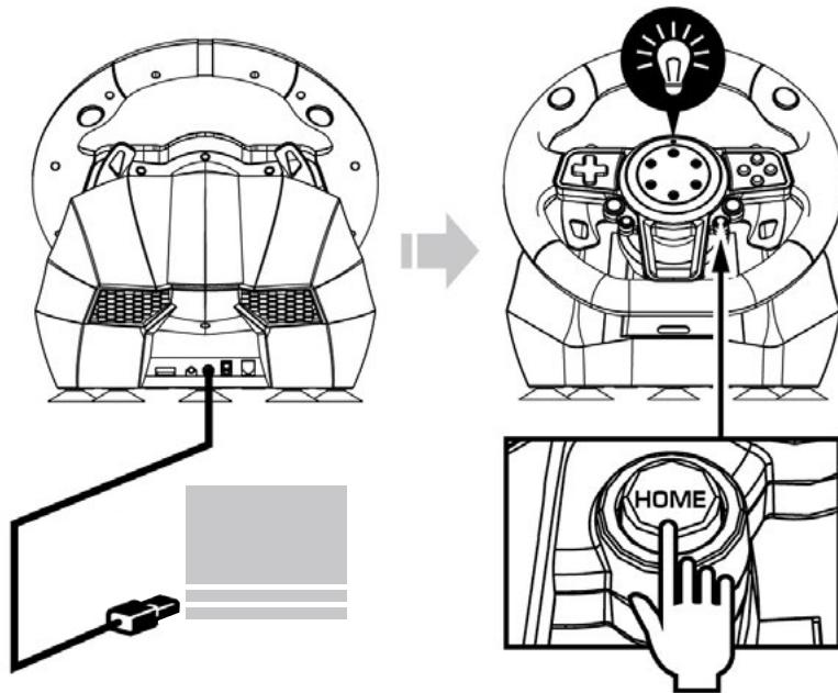
4. Connecteu el cable USB del volant a la PS4™ i premeu el botó "HOME" per connectar el volant. El LED vermell del volant s'encendrà quan acabi la connexió.
