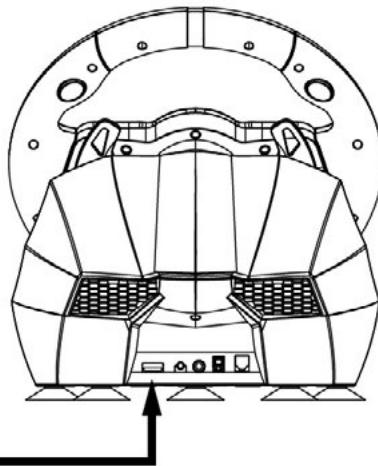
3. قم بتوصيل جهاز القيادة و التحكم عن بعد XB الأصلي، مع كبل التوجيه، منفذ USB على عجلة القيادة. يجب إيقاف تشغيل جهاز القيادة و التحكم (XBOX Series X / S أو XBOX ONE)
