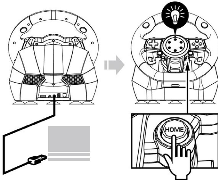
4. USB-Lenkradkabel mit der PS4™ verbinden und den Button "HOME" drücken, um das Lenkrad anzuschließen. Die rote LED des Lenkrads geht an, sobald die Verbindung abgeschlossen ist.
