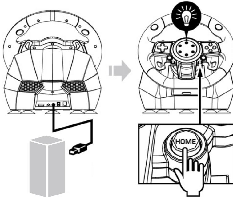
4. Das USB-Lenkradkabel am USB-Port der XBOX ONE™ oder XBOX Series X/S anschließen. Sobald die rote LED am Lenkrad angeht, den Button "HOME" drücken, um die Lenkradverbindung abzuschließen.
