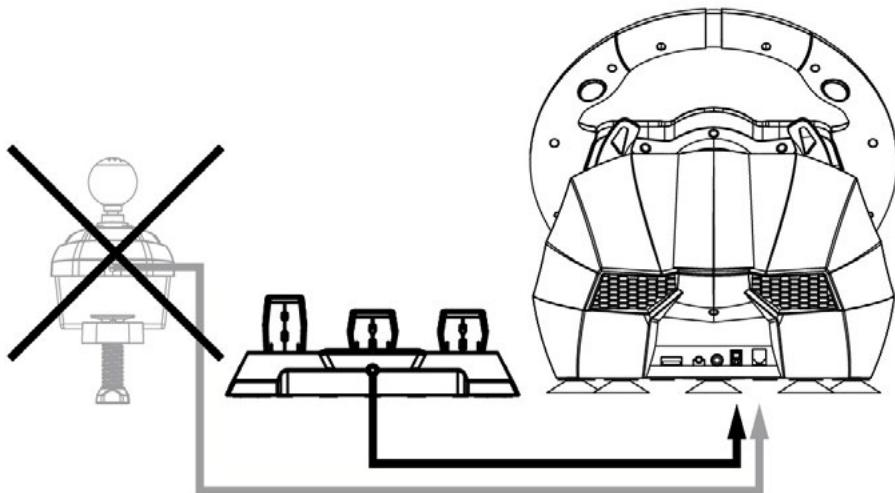
2. Connectez les pédales au port des pédales sur le volant.
