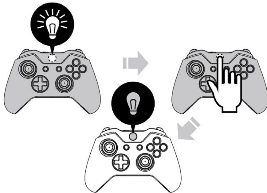
2. De XB-controller uitzetten (indien de led brandt, geeft dit aan dat de XB-controller is verbonden met de Xbox™-console): Op de knop X van de XB-controller drukken tot de led is uitgeschakeld.
