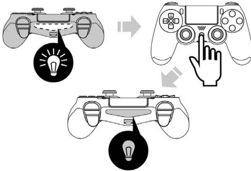
2. De DualShock4™-controller uitschakelen (de blauwe led die brandt geeft aan dat de DualShock4™-controller is aangesloten op de PS4™-console):
