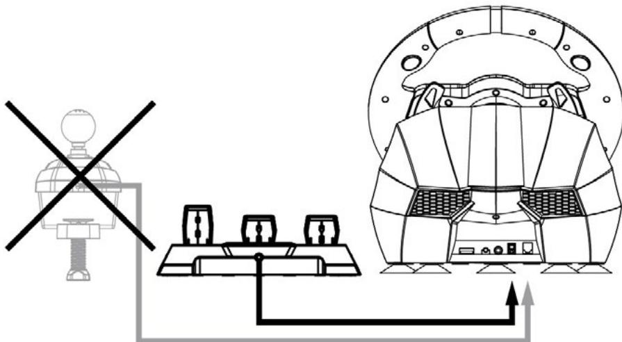
2. Pedale mit Pedalanschluss des Lenkrads verbinden.
