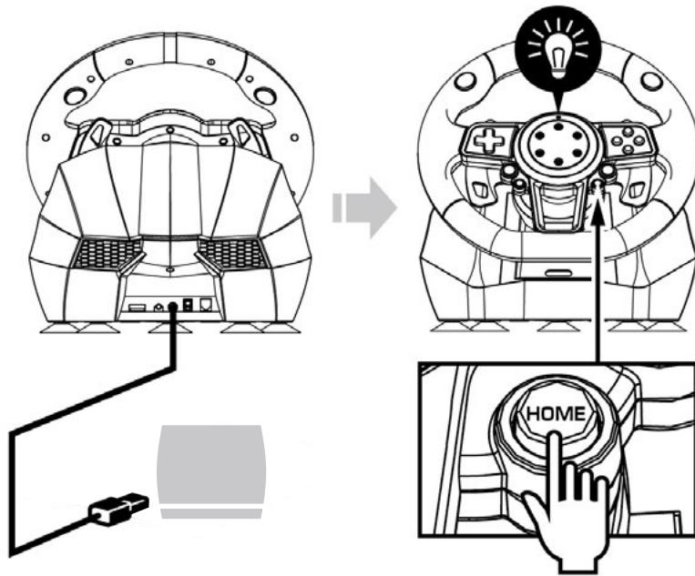
2. De USB-kabel van het stuur aansluiten op de PS3™ en drukken op de knop 'HOME' om het stuur te verbinden. De rode led van het stuur gaat branden wanneer de verbinding is beëindigd.
