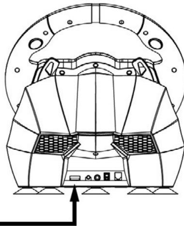
3. Collegare il controller XB originale mediante il cavo alla porta USB sul volante (il controller della XBOX ONE™ o della XBOX Serie X/S deve essere spento).
