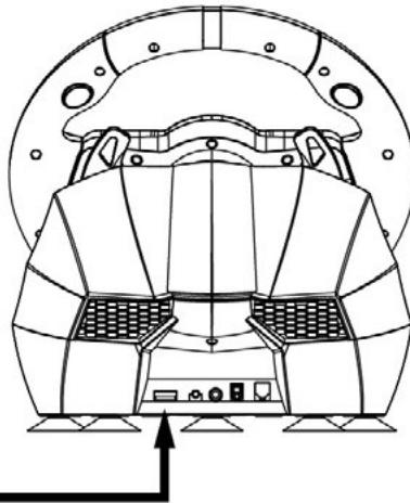
3. De originele DualShock4™-controller met de geleidingskabel aansluiten op de USB-poort van het stuur. (De DualShock4™-controller moet uitgeschakeld zijn)
