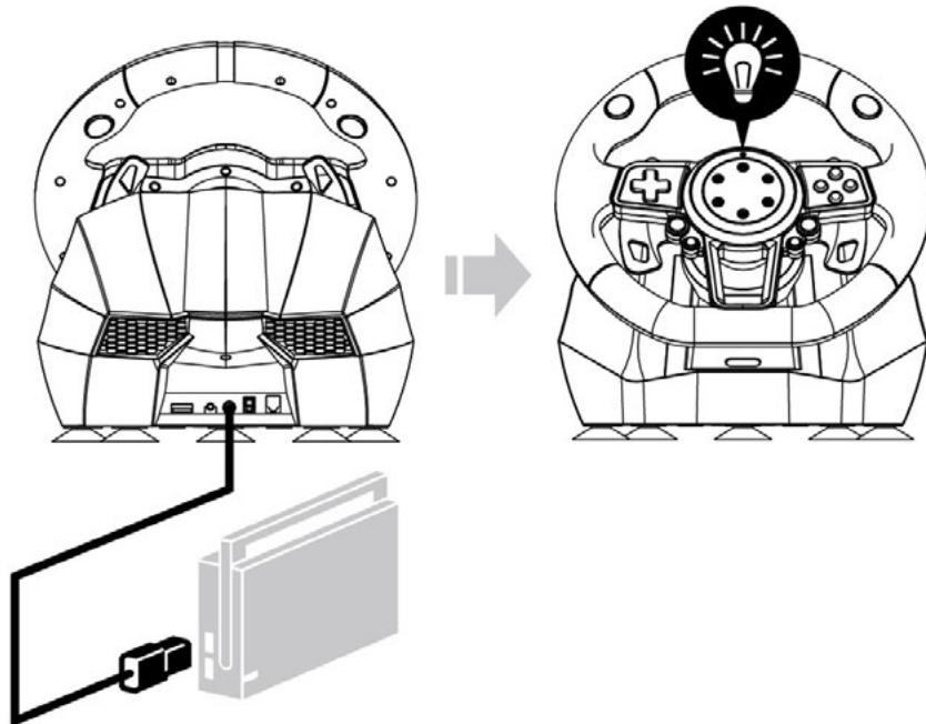
3. Conectar el volante de conexión mediante el cable USB al Puerto USB ubicado en el Dock™ de Nintendo Switch™. Cuando el LED rojo del volante esté encendido, ya está listo para usarse.
