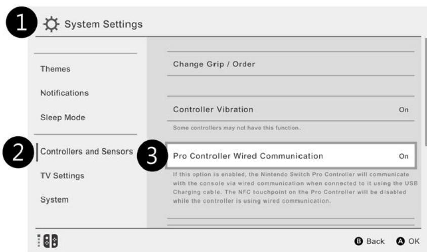
1. Se nunca utilizou o comando original “Switch Pro Controller”, siga os passos abaixo para ativar a função de ligação de comandos através de cabo.
