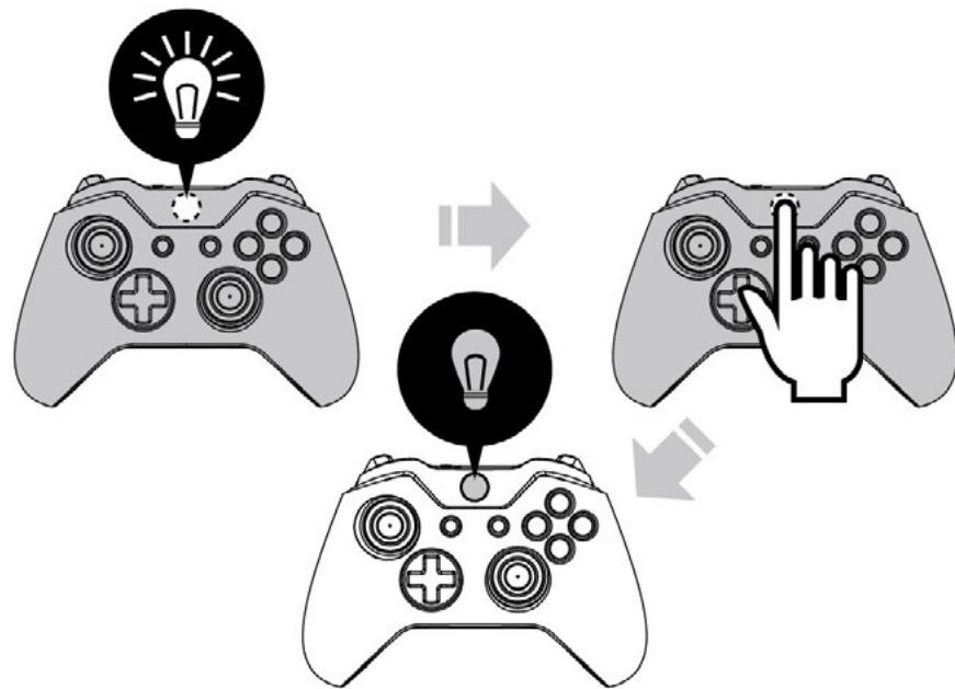
2. XB-Controller ausschalten (Wenn die LED leuchtet, ist der XB-Controller mit der Xbox™ Konsole verbunden): Halten Sie den Button X des XB Controller gedrückt, bis die LED erlischt.
