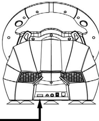
3. De originele XB-controller met de geleidingskabel aansluiten op de USB-poort van het stuur.
