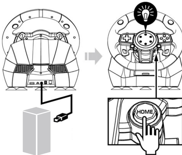
4. De USB-kabel van het stuur aansluiten op de USB-poort van de XBOX ONE™ of XBOX Series X/S. Wanneer de rode led van het stuur gaat branden, drukken op de knop 'HOME' om de aansluiting van het stuur te beëindigen
