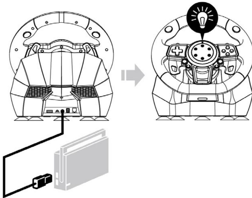
3. Collegare il volante di collegamento tramite il cavo USB alla porta USB situata sul Dock™ della Nintendo Switch™. Quando il LED rosso sul volante è acceso, è pronto per l'uso.
