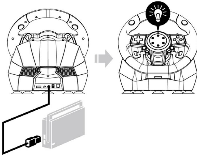
3. Connectez le volant par câble USB au port USB situé sur le Dock™ de la Nintendo Switch™. Lorsque la LED rouge sur le volant est allumée, il est prêt à être utilisé.
