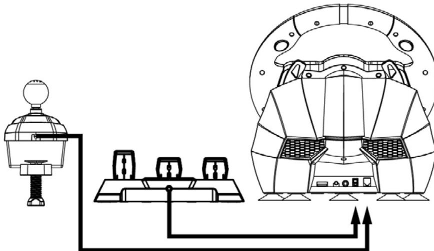
1. Schließen Sie die Pedale und die Handschaltung an die entsprechenden Anschlüsse des Lenkrads.
