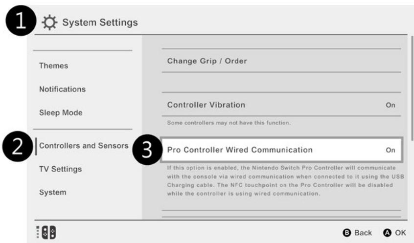
1. Wenn Sie den Original-Controller "Switch Pro Controller" zum ersten Mal benutzen, führen Sie bitte folgende Schritte aus, um die Kabelverbindungsoption für Controller zu aktivieren
