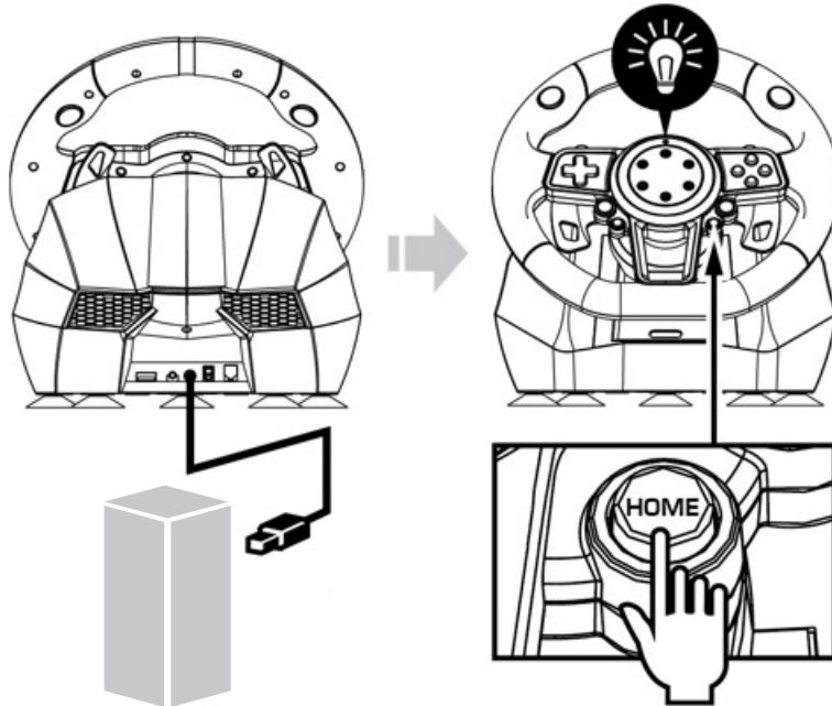
4. Ligar o cabo USB do volante à porta USB da XBOX ONE™ ou XBOX Series X/S. Quando o LED vermelho do volante acender, pressionar o botão “HOME” para finalizar a ligação do volante.
